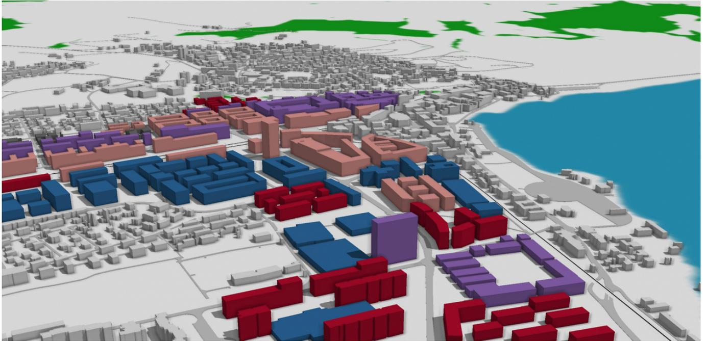
**swisstopo beauftragte EBP, die Gebäudehöhen der Schweiz aus verschiedenen Gebäudegrundrissen zu berechnen. Die Methode von EBP erlaubt eine Berechnung aus Milliarden von Laserscanning-Punkten. swisstopo vertreibt den Datensatz als neues Produkt unter dem Namen SwissBUILDINGS3D.**
