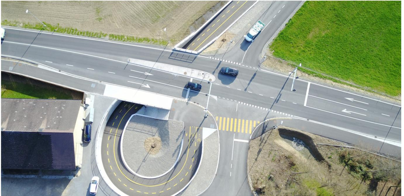
**Am Knoten Wehntaler-/Altburgstrasse in Regensdorf wurde der Fussgängerstreifen durch eine Unterführung ersetzt. Zudem wurde der Knoten neu gestaltet. EBP erbrachte die Ingenieurleistungen für die Phasen Bauprojekt, Ausschreibung und Ausführungsprojekt sowie die Fachbauleitung.**
