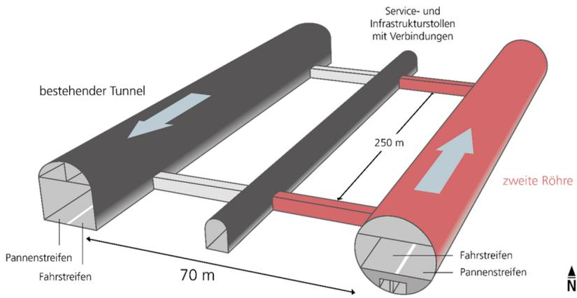
Konzept Gotthard-Strassentunnel mit 2. Röhre (Neubauteil in Rot)
