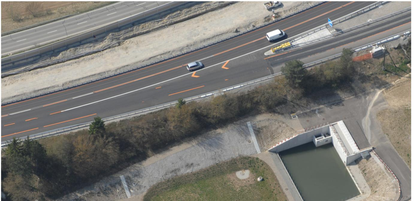
**Die Nationalstrasse N4 wurde zwischen Andelfingen und Flurlingen auf vier Spuren ausgebaut und die Strassenentwässerung an die aktuelle Gewässerschutzgesetzgebung angepasst. EBP wirkte massgebend bei Projektierung und Baubegleitung mit.**
