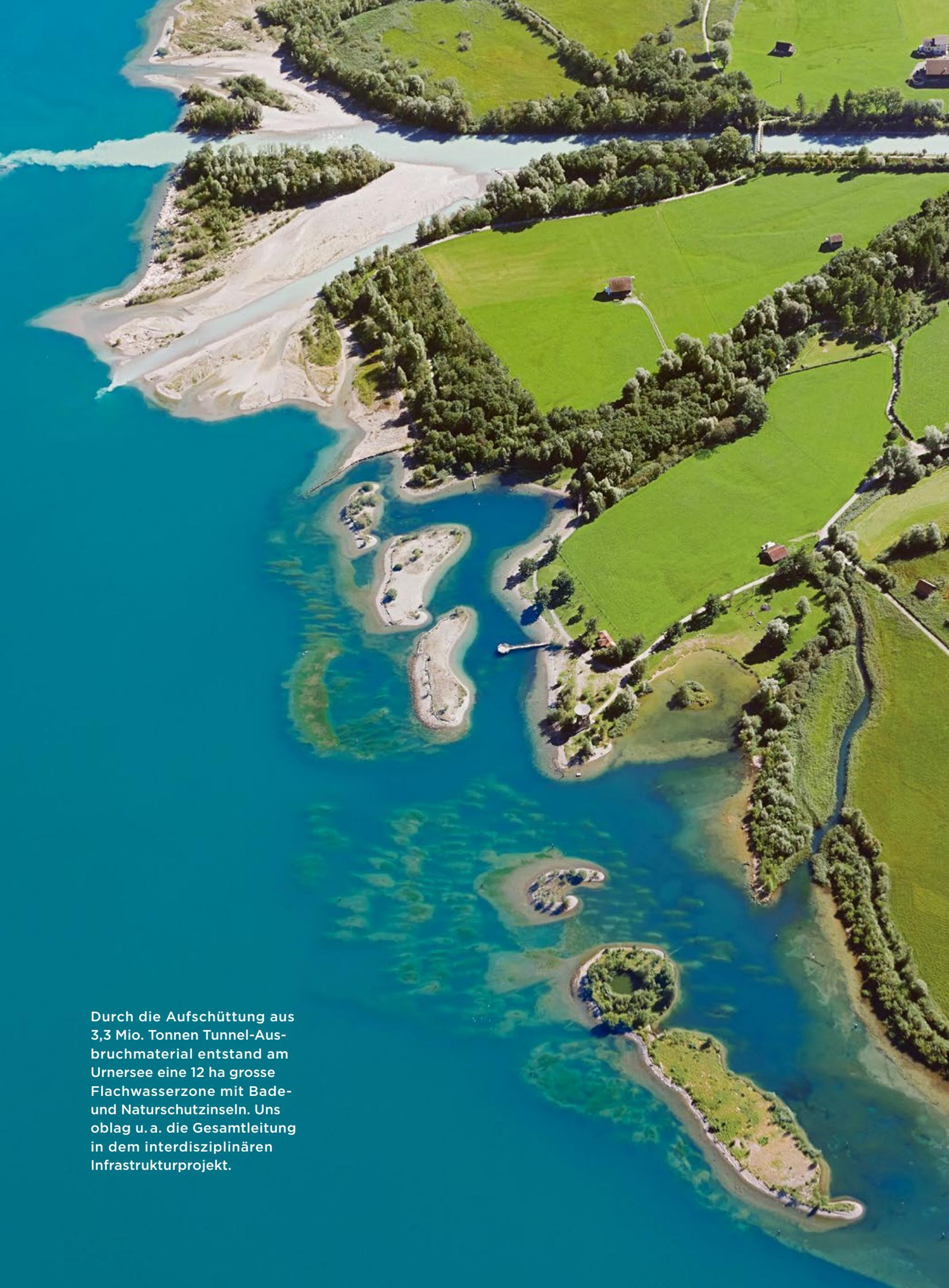
Durch die Aufschüttung aus 3,3 Mio. Tonnen Tunnel-Ausbruchmaterial entstand am Urnersee eine 12 ha grosse Flachwasserzone mit Bade- und Naturschutzinseln. Uns oblag u. a. die Gesamtleitung in dem interdisziplinären Infrastrukturprojekt.
