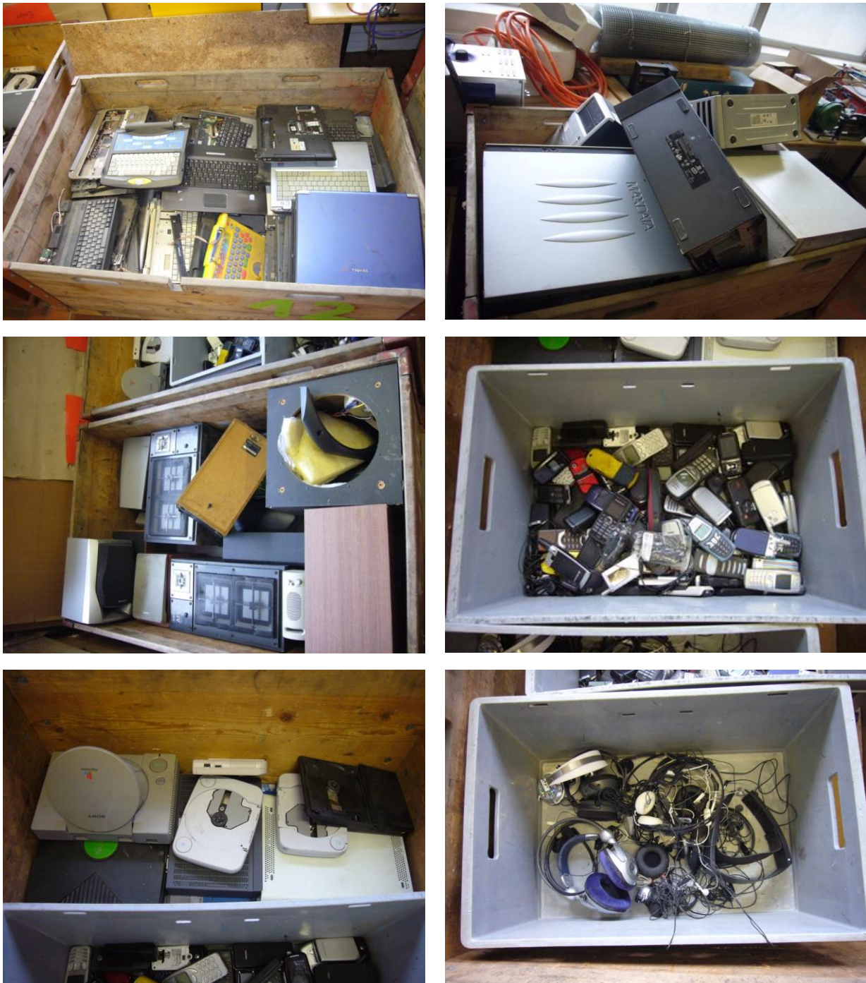
Abbildung 7-9: Ausgangsmaterial für die Zerlegeversuche von Mobiltelefonen, Kopfhörern, Lautsprecherboxen, Dockingstations und Tablets (Fotos: Empa)
