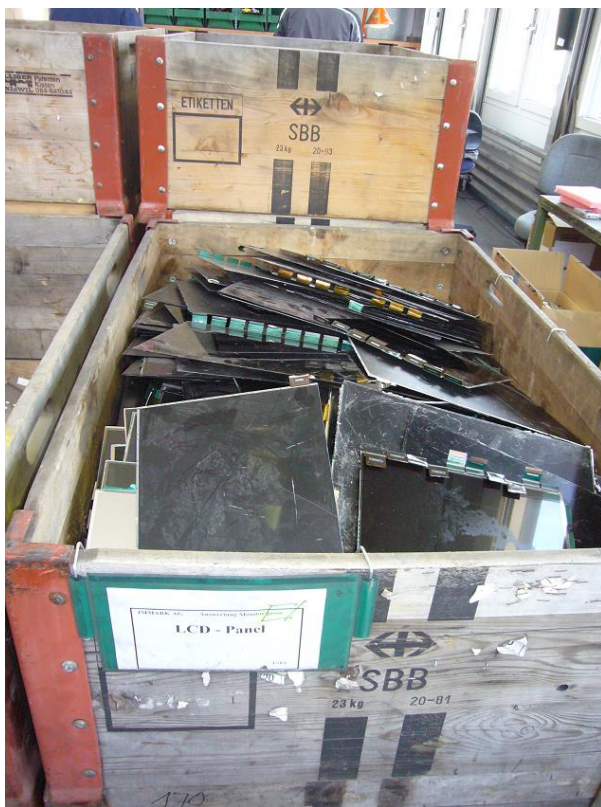
Abbildung 6-1: LCD-Panels aus der Zerlegung von Flachbildschirmen (Fotos: Empa)
