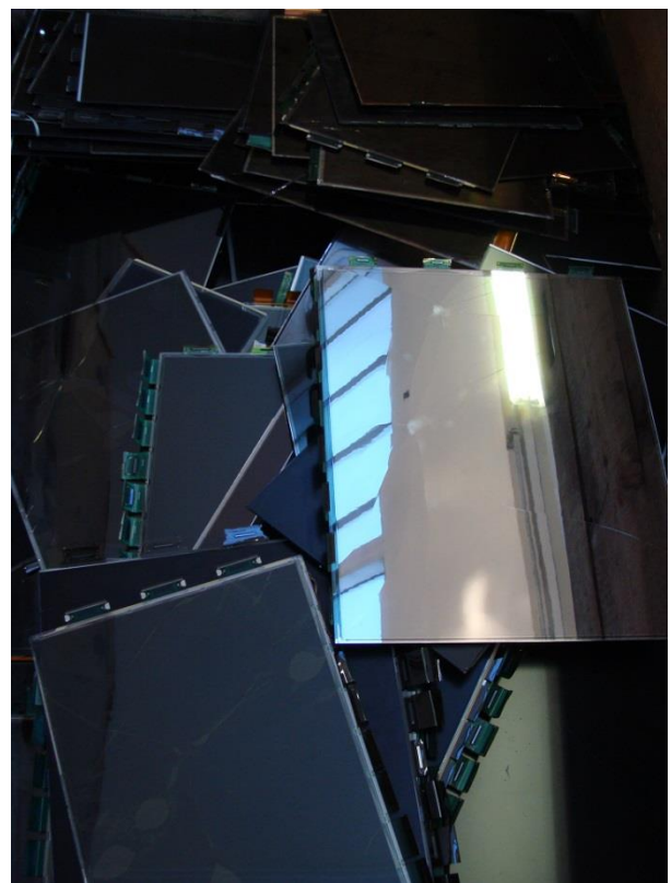
Abbildung 6-1: LCD-Panels aus der Zerlegung von Flachbildschirmen (Fotos: Empa)
