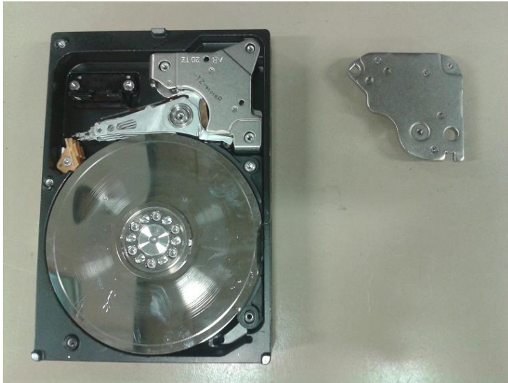
Abbildung 6-2: Harddisk mit Neodym-Eisen-Bor Magneten (Fotos: Umtec)
