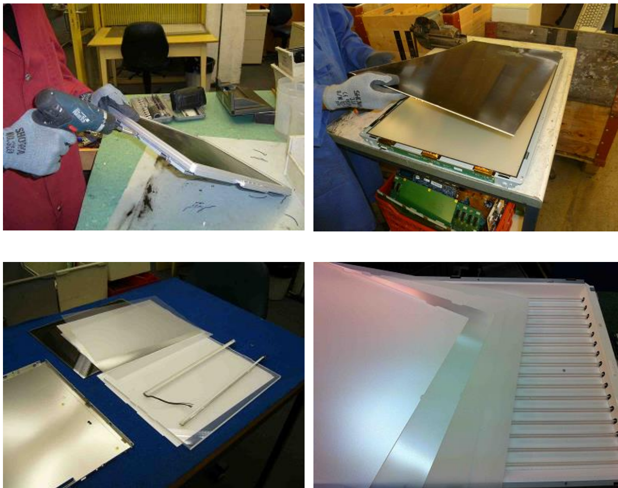
Abbildung 7-3: Manuelle Zerlegung von Flachbildschirmen (Fotos: Bird-RDS SA)
