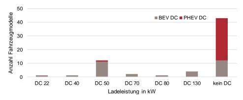
Abbildung 5: Maximale DC-Ladeaufnahmeleistungen (Stand Ende 2017, EBP).
