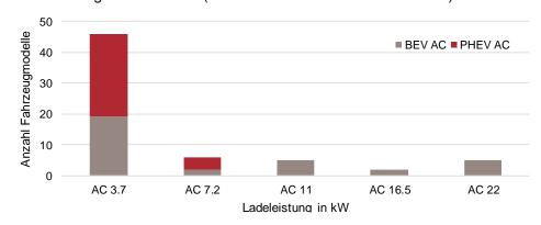
Abbildung 4: Maximale AC-Ladeaufnahmeleistungen (Stand Ende 2017, EBP).
